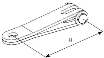
Verlängerungstoggle zur Montage unter die Furlex zum Freihalten von z.B. Anker etc.
