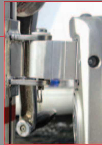
• Kreuzgelenk Diese werden angefertigt für existierende Beschläge am Mast. Keine Löcher im Mast für neue Beschläge.
